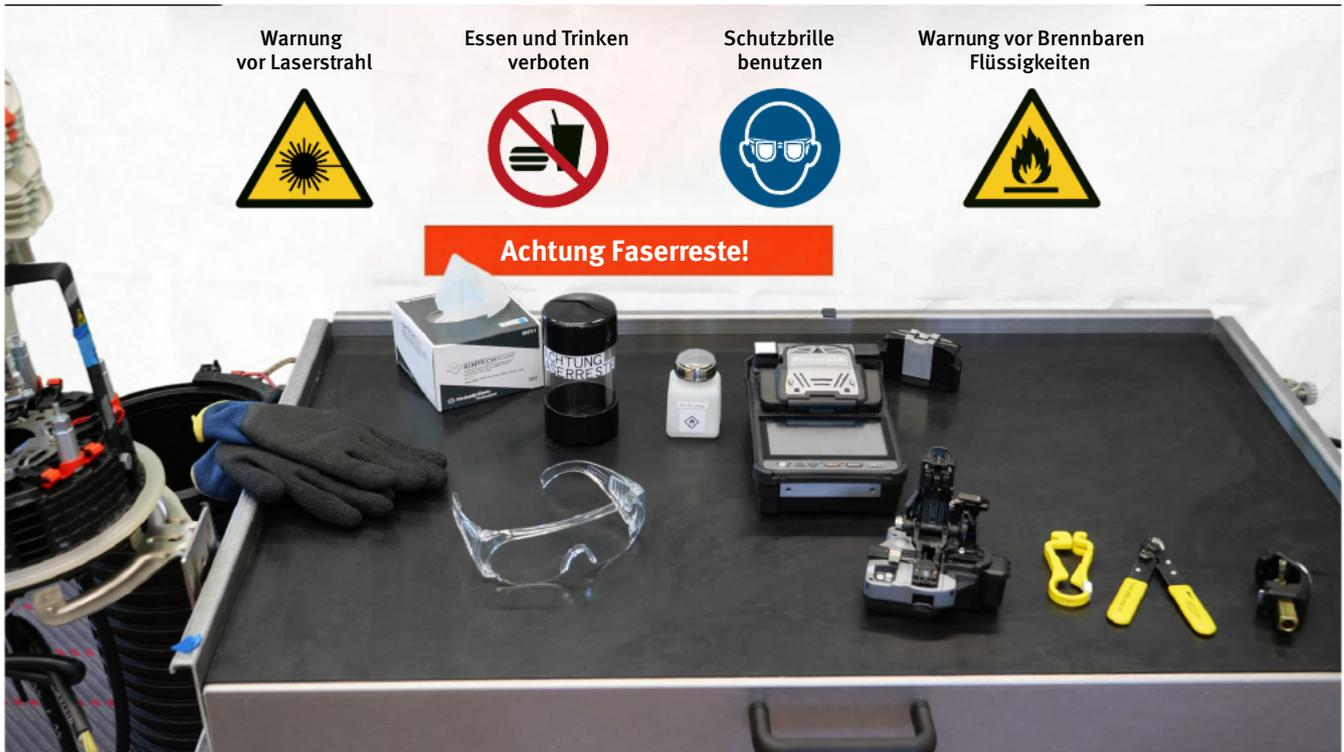
Abb. A3.15 Arbeitsplatz zum Herstellen eines mechanischen Spleißes (tragbarer Tisch für Außendienstmonteure)
